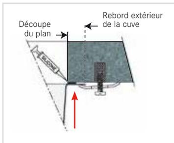
La cuve (ou l'évier) vient se fixer sous le plan de travail. Il convient d'effectuer scrupuleusement la découpe du plan à l'aide du gabarit ou d'un plan coté.
